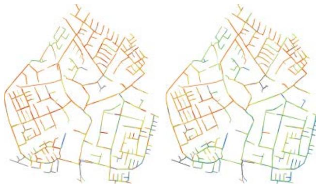
Abb. 4: Reales Teilnetz mit 1337 Haltungen: Zustandsklassen (links) und Substanzklassen (rechts), Farbgebung gemäß Tabelle 5
